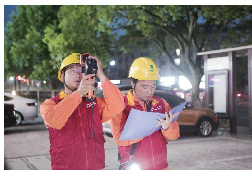
测温外，晚上也有安排对涉及城区供电的多条35千伏线路的运行状况进行红外测温，以补充完善白天巡视测温中不易发现的问题和缺陷，为科学制定检修、消缺计划，提供一套客观、详实的基础数据。”在红外测温过程中，该公司输电运检班巡视人员说。
