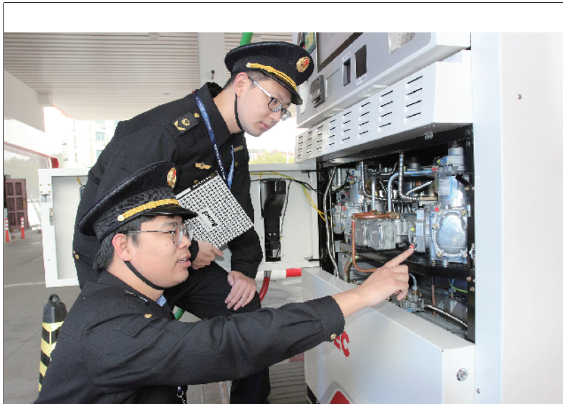
连日来,县市场监管局会同县纪委监委对全县44家燃油加油站(点)开展燃油加油机计量准确性专项治理。通过签订诚信计量承诺书、强制检定计量器具、公示合格标志等,严厉打击燃油加油机计量违法行为,维护消费者权益。图为4月17日该局监管人员在城区某加油站检查加油机铅封。
