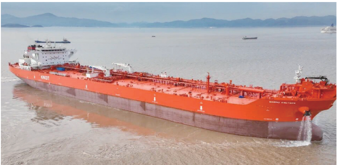
中远海运建造的15.4万载重吨穿梭油轮。(舟山中远海运重工供图)
