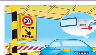
全自动电子收费系统(ETC, Electronic Toll Collection),是智能交通系统的服务功能之一。车主只要在车辆上安装ETC感应装置,通过收费站时无须停车,两秒不到即可实现高速通行费自动扣除,实现自动收费。
