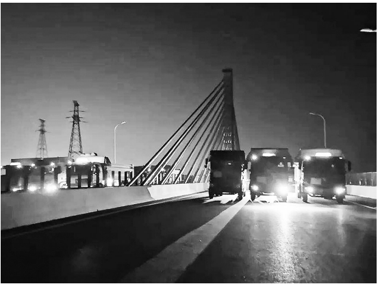
桥梁荷载试验工作现场。张燎原/摄
