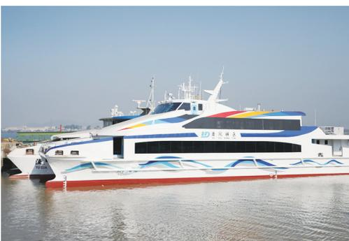
**普陀** ▲日前,舟山市首艘双体高速客船“普陀祥云”轮成功完成全船合拢。该船设计总长40.35米,型宽10.38米,最大航速23Kn,总载客量280客位。
