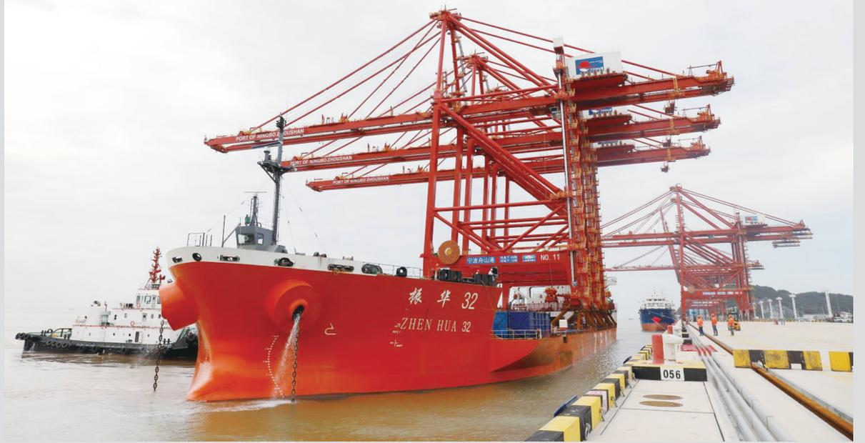
▲日前,3台遥控自动化桥吊搭乘“振华32”运输船顺利抵达金塘港区。这批桥吊由浙江海港海洋工程建设有限公司为宁波舟山港金塘港区二阶段3号至5号集装箱码头工程采购的第一批次智能遥控自动化桥吊,起升高度49米,外伸距70米,安装有集卡引导系统、箱型扫描系统、操作视频监控系统、防摇防扭系统等辅助设备。
