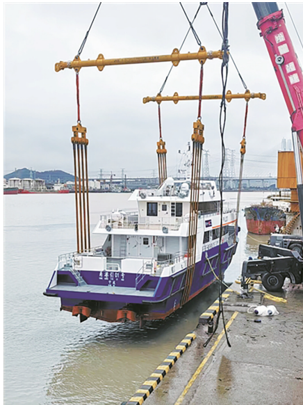
吊装下水现场。沈孙晖/摄
