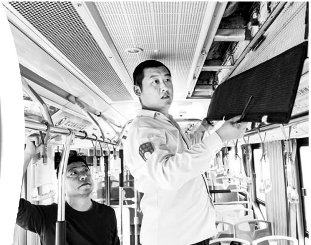
近日,金华市交投公交集团客运金西公司工作人员对503路公交车的车载空调进行换季维护和保养工作,重点对暖风机、空调线路和水暖管道等设施进行检测,确保车载空调系统运转正常,同步对空调出风口及过滤网罩进行清洗,确保送风功能良好。气温逐渐降低,金华市交投公交集团抓紧时间开展公交车空调系统清洗消毒保养工作,提升乘客乘车期间的舒适性和安全性。
