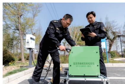
昨天,市场监管局计量所的工作人员来到新仓镇一公共充电站,根据检定规程开展项目检定。据介绍,近期计量所将陆续对全市面向全社会提供充电服务的贸易结算用充电桩实施常态化强制检定,保障电动汽车充电设施量值准确性。
