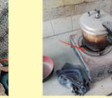
无熄火保护装置的燃气灶
