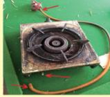
软管老化、无管扣,脱落漏气
