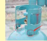
螺丝连接的报废气瓶
