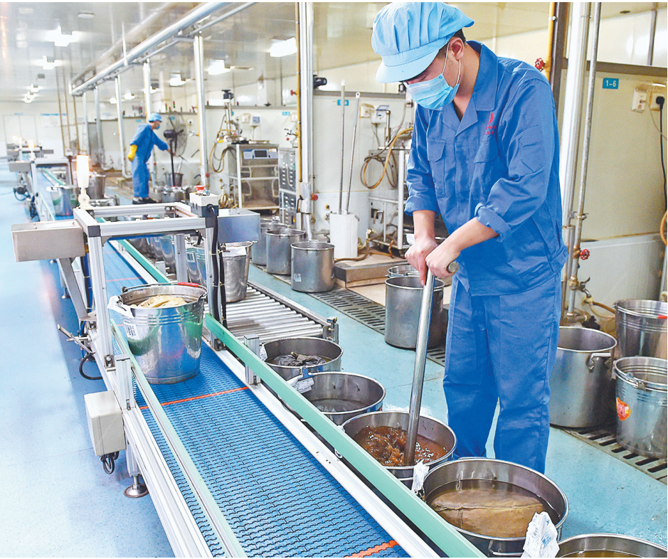
膏方制作区,药工对经过浸泡的中药材进行压榨。
