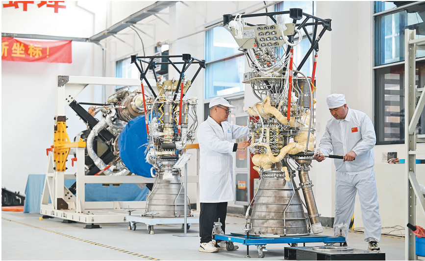
2024年3月11日,在安徽九州云箭航天技术有限公司生产基地,技术人员对即将交付的液体火箭发动机进行最后的检查。 新华社发 黄洋洋 摄
